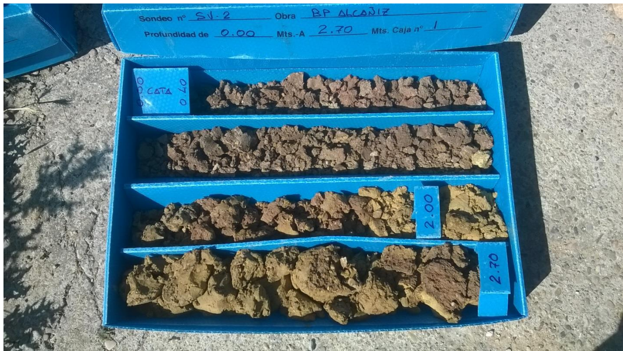
Photo 8. SV2 core box 0,0 m to 2,70 m.
