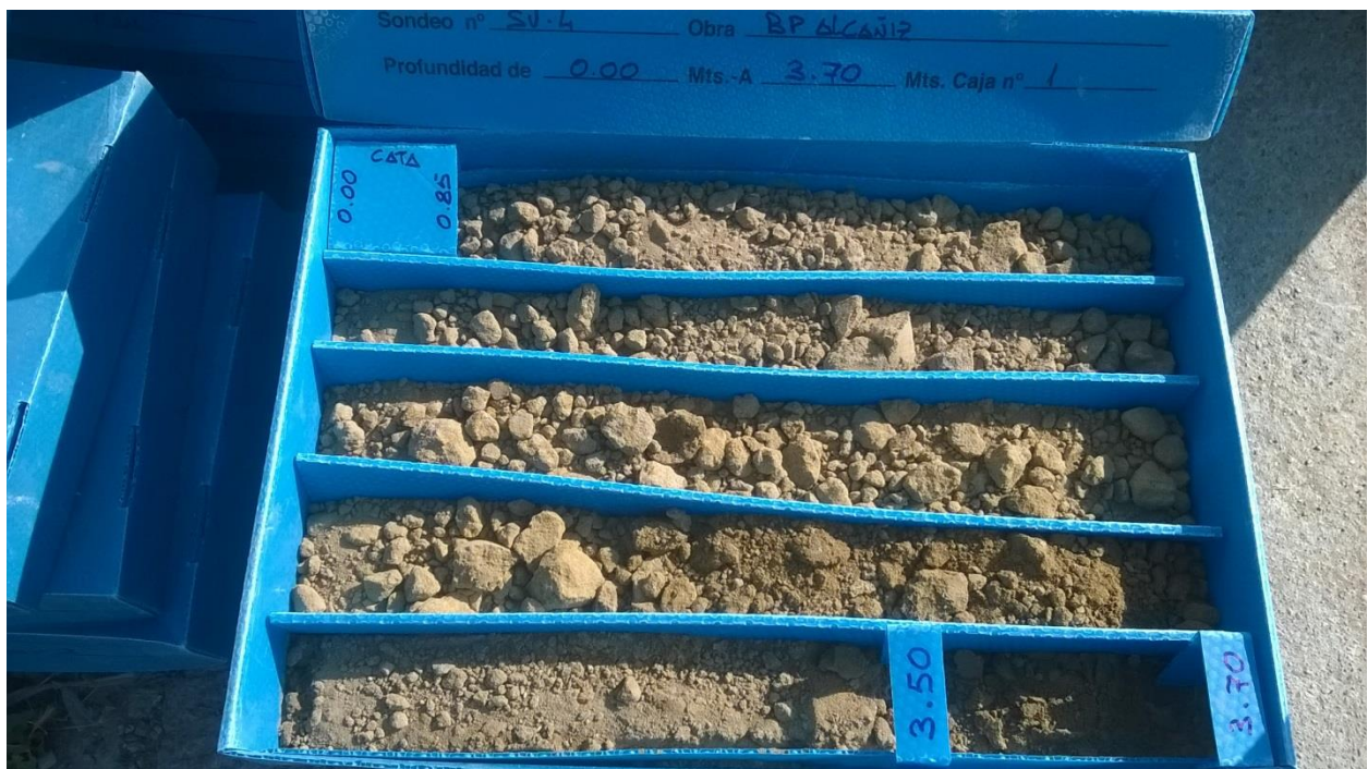
Photo 18. SV4 core box 0,00 m to 3,70 m.
