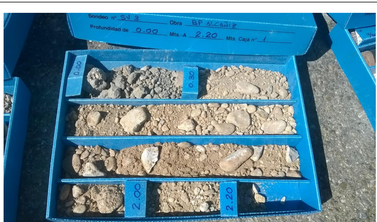
Photo 13. SV3 core box 0,00 m to 2,20 m.
