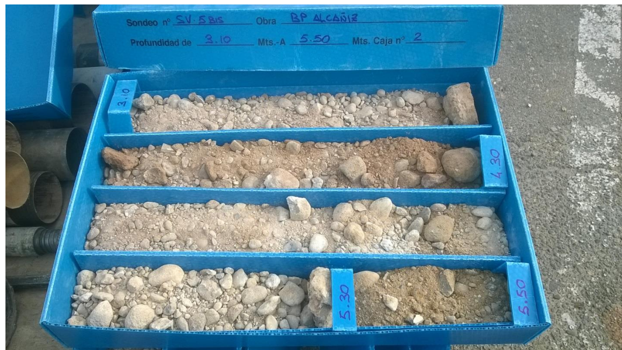
Photo 28. SV5 core box 3,10 m to 6,10 m.
