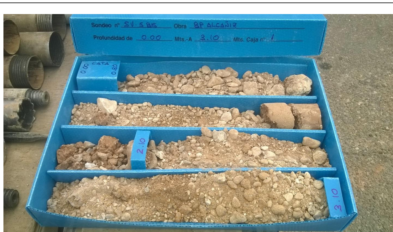
Photo 27. SV5 core box 0,0 m to 3,10 m.
